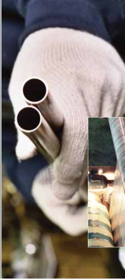
Dieses Stahlrohr ist abgelängt und entgratet, begann seinen Weg durch die Produktion von MARKIN aber als Flachstahl beim Längsschneiden (links).
