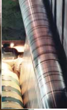
Dieses Stahlrohr ist abgelängt und entgratet, begann seinen Weg durch die Produktion von MARKIN aber als Flachstahl beim Längsschneiden (links).
